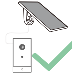
Säkerställ att strömkabeln ligger naturligt utan spänning
